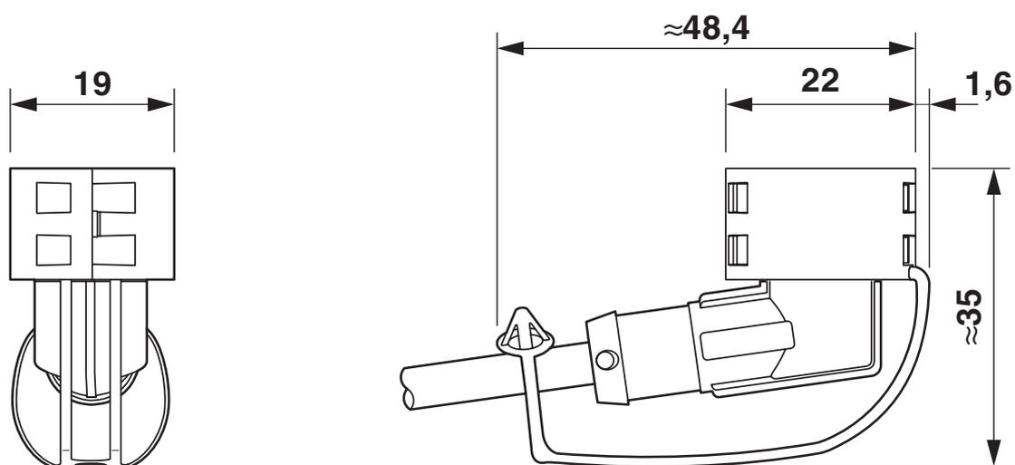
Connettore maschio montato con EXCLIP
