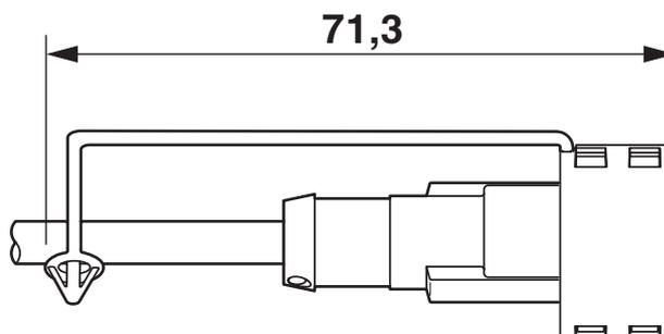
Connettore maschio montato con EXCLIP
