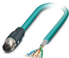
Cavo di rete, Ethernet CAT5 (1 Gbit/s), 8-poli, PUR senza alogenati, azzurro mare RAL 5021, schermata, Maschio diritto M12 SPEEDCON, codifica: A / IP67, su estremità conduttore libera, lunghezza cavo: 5 m
