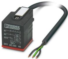
Cavo sensore/attuatore, 3-poli, PUR senza alogenati, nero RAL 9005, estremità conduttore libera, su Connettore per valvole A, con 1 LED , Circuito: Diodo Z, lunghezza cavo: 5 m, per applicazioni outdoor , con vite centrale in acciaio inox e guarnizione supplementare in silicone (rossa)
