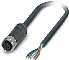
Cavo sensore/attuatore, 5-poli, PE-X senza alogenati, grigio-nero RAL 7021, estremità conduttore libera, su Connettore femmina diritto M12, codifica: A, lunghezza cavo: 2 m, per applicazioni outdoor , con zigrinatura in acciaio inox
