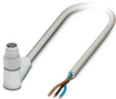
Cavo sensore/attuatore, 3-poli, PP-EPDM senza alogenati, grigio RAL 7035, Maschio angolato M8, codifica: A, su estremità conduttore libera, lunghezza cavo: 1,5 m, Hygienic Design, con ghiera in plastica
