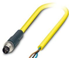
Cavo sensore/attuatore, 3-poli, PVC, giallo, Maschio diritto M8, su estremità conduttore libera, lunghezza cavo: 2 m
