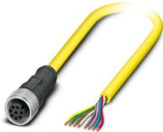
Cavo sensore/attuatore, 8-poli, PVC, giallo, estremità conduttore libera, su Connettore femmina diritto M12, codifica: A, lunghezza cavo: 5 m
