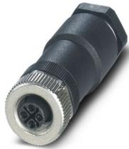
Connettore Power, Potenza, 4-poli, Femmina diritto M12, codifica: S, Connessione a vite, materiale zigrinato: Pressogetto di zinco, nichelato, connessione a vite per cavo Pg11, diametro esterno conduttore 8 mm ... 10 mm, per corrente alternata fino a 12 A/630 V
