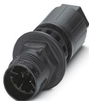
Connettore per linee-passaparete su un lato con dado QPD, nero, 4+PE poli, 1,0 mm<sup>2</sup> ... 2,5 mm<sup>2</sup> / 690 V / 20 A, per diametro cavi 6 mm ... 11 mm.
