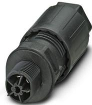
Passaparete, tipo di connessione: Connessione Faston (per spine femmina Faston a norma DIN 46247-2)/ Connessione IDC, numero poli: 4+PE, M20, Spina, 1 mm<sup>2</sup> ... 2,5 mm<sup>2</sup>, 690 V, 20 A, PA, nero, con dado QUICKON, codifica: codificato, diametro esterno conduttore: 6 mm ... 11 mm
