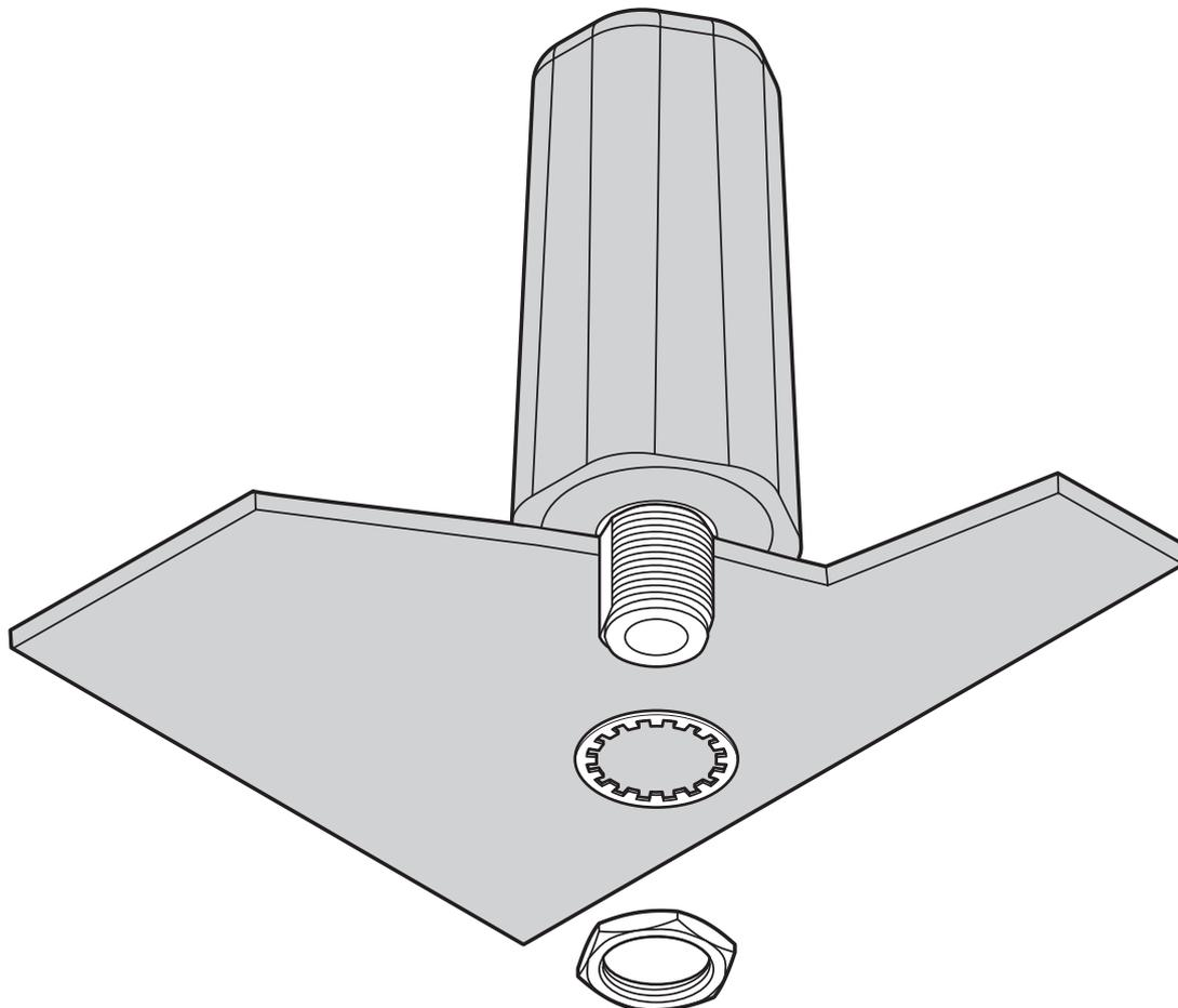
Montaggio sull'armadio di comando
