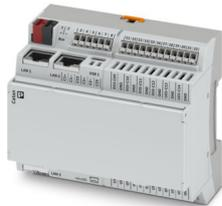
Controllore per l'automazione di edifici. 14 ingressi e uscite configurabili. Interfacce: 3 x Ethernet, 2 x RS-485, 2 x USB-C, TP per automazione di locali, 2 x SPE per moduli di espansione Catan. Funzionamento a priorità locale tramite il pannello di controllo Catan.
