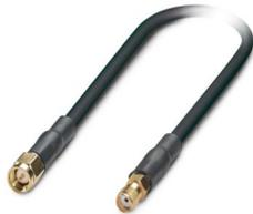
Cavo coassiale 50  $\Omega$ , lunghezza: 5 m, SMA(m) - SMA(f), diametro esterno del cavo: 4,9 mm, frequenza di trasmissione:  $\leq$  7,25 GHz, attenuazione tipica: 800 MHz 2,3 dB, 2,4 GHz 3,8 dB, 5,8 GHz 6 dB, 7,25 GHz 7,3 dB
