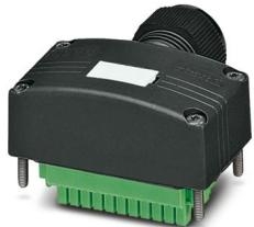
Custodia mobile, applicazione: Box sensore/attuatore, tipo di connessione: Connettore femmina M12 Metallo / QUICKON, numero degli slot: 8, occupazione slot: doppi, segnalazione di stato: no; connessione linea principale: Morsetto a vite estraibile 180°, PUR/PVC, lunghezza cavo: 30 m, schermatura: no
