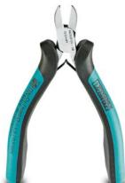
Tronchesino a taglio laterale per elettronica, testa rotonda, senza smusso, con molla di apertura, lucidato a specchio e oliato, manico a 2 componenti, diametro capacità di taglio: morbido 0,2 ... 2,0 mm; semirigido 1,2 mm; rigido 0,5 mm, confezione: con supporto per espositore da negozio (backcard)
