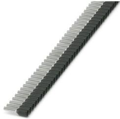
Capocorda a nastro, 1,5 mm<sup>2</sup>, lunghezza guaine 8 mm, con collare in plastica, a norma DIN 46228-4, colore nero, dotato di estremità funzionale per la lavorazione sicura e pratica con Crimphandy, 20 strisce con ciascuna 50 guaine.
