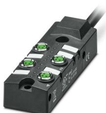
Scatola di distribuzione, applicazione: Standard, tipo di connessione: Connettore femmina M8 Metallo, numero degli slot: 4, numero poli: 3, codifica: A, occupazione slot: singolo, segnalazione di stato: sì, PNP; connessione linea principale: Attacco fisso 180°, PUR/PVC, lunghezza cavo: 10 m, schermatura: no
