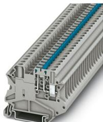
Morsetto con sezionatore a coltello, con linguetta di azionamento, sezionatore a coltello rosso e viti per prese di prova per l'alloggiamento di spine di prova, tensione nominale: 500 V, corrente nominale: 20 A, tipo di connessione: Connessione a vite, Sezione di dimensionamento: 2,5 mm<sup>2</sup>, sezione: 0,14 mm<sup>2</sup> - 6 mm<sup>2</sup>, montaggio: NS 35/7,5, NS 35/15, colore: blu
