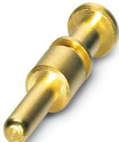
Contatto a crimpare, serie: VARIOCON, Spina, tornito, diametro contatti: 2 mm, sezione di connessione: 0,35 mm<sup>2</sup> ... 1 mm<sup>2</sup>, AWG 20...18, materiale contatti: Cu, questo articolo dovrebbe essere privo di piombo dal quarto trimestre 2026 secondo la RoHS II senza l'eccezione 6c (Pb < 0,1 %), un'alternativa priva di piombo è disponibile in anticipo su richiesta
