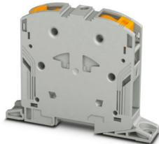
Morsetti di potenza, con connettore femmina di prova, tensione nominale: 1000 V, corrente nominale: 150 A, numero di connessioni: 2, numero poli: 1, tipo di connessione: Connessione PowerTurn, 1. piano, sezione: 10 mm<sup>2</sup> - 70 mm<sup>2</sup>, tipo di montaggio: avvitamento diretto, colore: grigio
