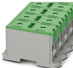
Morsetti di potenza, tensione nominale: 1000 V, corrente nominale: 380 A, numero di connessioni: 2, numero poli: 1, tipo di connessione: Connessione a vite, Sezione di dimensionamento: 240 mm<sup>2</sup>, sezione: 35 mm<sup>2</sup> - 240 mm<sup>2</sup>, Sezione di dimensionamento: 240 mm<sup>2</sup>, sezione: 35 mm<sup>2</sup> - 240 mm<sup>2</sup>, tipo di montaggio: Montaggio a vite, colore: verde
