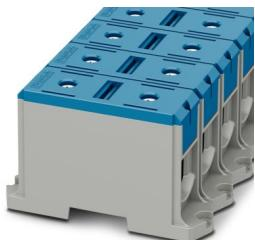
Morsetti di potenza, tensione nominale: 1000 V, corrente nominale: 380 A, numero di connessioni: 2, numero poli: 1, tipo di connessione: Connessione a vite, Sezione di dimensionamento: 240 mm<sup>2</sup>, sezione: 35 mm<sup>2</sup> - 240 mm<sup>2</sup>, Sezione di dimensionamento: 240 mm<sup>2</sup>, sezione: 35 mm<sup>2</sup> - 240 mm<sup>2</sup>, tipo di montaggio: Montaggio a vite, colore: blu
