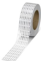
Targhetta per cavi, Rotolo, bianco, in bianco, siglabile con: THERMOMARK E.300 (D)/600 (D), THERMOMARK ROLL 2.0, THERMOMARK ROLL, THERMOMARK ROLL X1, THERMOMARK ROLLMASTER 300/600, THERMOMARK X1.2, diametro cavi: 0,6 ... 45 mm, tipo di montaggio: inserire, Numero dei cartellini singoli: 6000, altezza del campo di testo: 4 mm, larghezza del campo di testo: 15 mm
