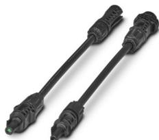
Set di adattatori per fotovoltaico, Serie di prodotti: SUNCLIX, tipo: Adattatore, colore: nero, corrente nominale: 35 A, lunghezza cavo: 150, Collegare i connettori solo con connettori dello stesso produttore e dello stesso tipo. Per il collegamento osservare assolutamente le indicazioni sulla tensione nominale e sulla corrente nominale. È permesso il valore comune minimo.
