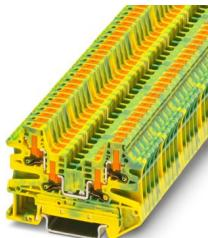
Morsetti comp. per conduttori terra, numero di connessioni: 4, tipo di connessione: Connessione Push-in, Sezione di dimensionamento: 2,5 mm<sup>2</sup>, sezione: 0,14 mm<sup>2</sup> - 4 mm<sup>2</sup>, tipo di montaggio: NS 35/7,5, NS 35/15, colore: giallo-verde
