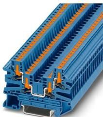
Morsetto passante componibile, tensione nominale: 800 V, corrente nominale: 24 A, numero di connessioni: 4, tipo di connessione: Connessione Push-in, Sezione di dimensionamento: 2,5 mm<sup>2</sup>, sezione: 0,14 mm<sup>2</sup> - 4 mm<sup>2</sup>, tipo di montaggio: NS 35/7,5, NS 35/15, colore: blu
