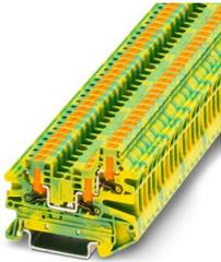
Morsetti comp. per conduttori terra, numero di connessioni: 3, tipo di connessione: Connessione Push-in, sezione: 0,14 mm<sup>2</sup> - 4 mm<sup>2</sup>, tipo di montaggio: NS 35/7,5, NS 35/15, colore: giallo-verde
