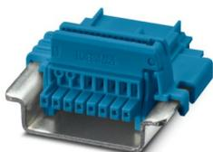
Connettore bus per guide DIN, colore: blu, corrente nominale: 6 A (contatti paralleli), tensione di dimensionamento (III/2): 32 V, numero poli: 8, serie di prodotti: TBUS8-25..., passo: 2,54 mm, montaggio: Montaggio su guida DIN, bloccaggio: assente, tipo di fissaggio: assente, tipo di confezione: confezionato nel cartone, Articolo con contatti dorati, connettore bus per il collegamento con custodie per l'elettronica, 8 contatti paralleli
