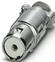
Connettore, numero poli: 1, contatti di potenza: 0, contatti di comando: 1, Femmina, Connessione a crimpare, 48 V, 16 A, 0,5 mm<sup>2</sup> ... 4 mm<sup>2</sup>, diametro esterno conduttore:3 mm ... 9,5 mm, applicazione: COAX, 50 Ω
