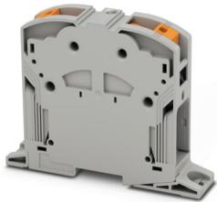
Morsetti di potenza, con connettore femmina di prova, tensione nominale: 1000 V, corrente nominale: 309 A, numero di connessioni: 2, numero poli: 1, tipo di connessione: Connessione PowerTurn, 1. piano, sezione: 95 mm<sup>2</sup> - 185 mm<sup>2</sup>, tipo di montaggio: avvitamento diretto, colore: grigio
