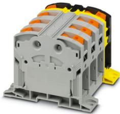
Morsetti di potenza, bloccato, tensione nominale: 1000 V, corrente nominale: 309 A, numero di connessioni: 8, numero poli: 4, tipo di connessione: Connessione PowerTurn, 1. piano, sezione: 95 mm<sup>2</sup> - 185 mm<sup>2</sup>, tipo di montaggio: avvitamento diretto, colore: grigio/nero-giallo
