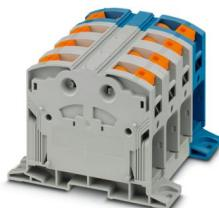
Morsetti di potenza, bloccato, tensione nominale: 1000 V, corrente nominale: 309 A, numero di connessioni: 8, numero poli: 4, tipo di connessione: Connessione PowerTurn, 1. piano, sezione: 95 mm<sup>2</sup> - 185 mm<sup>2</sup>, tipo di montaggio: avvitamento diretto, colore: grigio/blu
