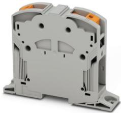
Morsetti di potenza, tensione nominale: 1000 V, corrente nominale: 309 A, numero di connessioni: 2, numero poli: 1, tipo di connessione: Connessione PowerTurn, 1. piano, sezione: 95 mm<sup>2</sup> - 185 mm<sup>2</sup>, tipo di montaggio: avvitamento diretto, colore: grigio
