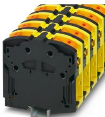
Morsetti di potenza, tensione nominale: 1000 V, corrente nominale: 309 A, numero di connessioni: 2, numero poli: 1, tipo di connessione: Connessione PowerTurn, 1. piano, sezione: 95 mm<sup>2</sup> - 185 mm<sup>2</sup>, tipo di montaggio: NS 35/15, colore: nero/giallo
