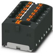
Blocco distributore, Morsetto base con alimentazione, tensione nominale: 450 V, corrente nominale: 17,5 A, numero di connessioni: 13, Presa, sezione: 0,14 mm<sup>2</sup> - 2,5 mm<sup>2</sup>, Connessione Push-in, Connessione collettiva, Sezione di dimensionamento: 4 mm<sup>2</sup>, sezione: 0,2 mm<sup>2</sup> - 6 mm<sup>2</sup>, tipo di montaggio: montaggio su adattatori per il fissaggio su guida di supporto, Montaggio diretto con flangia, Mobile, colore: nero
