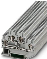
Componente morsetto componibile, con resistenza 10 kOhm per monitoraggio circuito aperto, 1. e 2. piano, tipo di connessione: Connessione a molla, Sezione di dimensionamento: 2,5 mm<sup>2</sup>, sezione: 0,08 mm<sup>2</sup> - 4 mm<sup>2</sup>, montaggio: NS 35/7,5, NS 35/15, colore: grigio
