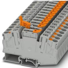
Morsetto con sezionatore a coltello, tensione nominale: 1000 V, corrente nominale: 32 A, tipo di connessione: Connessione Push-in, Sezione di dimensionamento: 6 mm<sup>2</sup>, sezione: 0,5 mm<sup>2</sup> - 10 mm<sup>2</sup>, montaggio: NS 35/7,5, NS 35/15, NS 32, colore: grigio
