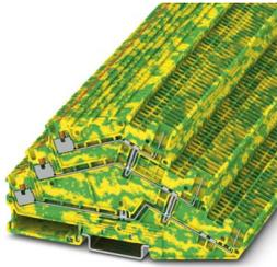
Morsetti comp. per conduttori terra, corrente nominale: 15 A, tipo di connessione: Push-in / attacco connettore, 1. piano, Sezione di dimensionamento: 1,5 mm<sup>2</sup>, sezione: 0,14 mm<sup>2</sup> - 1,5 mm<sup>2</sup>, tipo di montaggio: NS 35/7,5, NS 35/15, colore: giallo-verde
