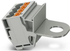
Morsetto di derivazione, tensione nominale: 1000 V, corrente nominale: 41 A, numero di connessioni: 5, tipo di connessione: Connessione Push-in, Sezione di dimensionamento: 6 mm<sup>2</sup>, 1. piano, sezione: 0,5 mm<sup>2</sup> - 10 mm<sup>2</sup>, Bullone, 1. piano, tipo di montaggio: sull'elemento base, colore: grigio
