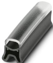
Portacartellini per conduttori, trasparente/nero, in bianco, diametro cavi: 2 ... 4 mm, tipo di montaggio: infilamento, altezza del campo di testo: 4 mm, larghezza del campo di testo: 23 mm
