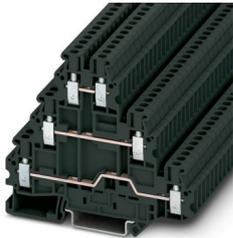
Morsetto a più piani, tensione nominale: 500 V, corrente nominale: 19 A, tipo di connessione: Connessione a vite, Sezione di dimensionamento: 2,5 mm<sup>2</sup>, sezione: 0,14 mm<sup>2</sup> - 4 mm<sup>2</sup>, tipo di montaggio: NS 35/7,5, NS 35/15, colore: nero
