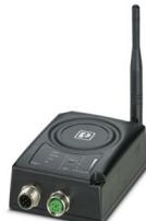
Modulo radio Ethernet combinato con Bluetooth e WLAN, antenna omnidirezionale sostituibile in dotazione, WLAN: AP e Client, 2,4 e 5 GHz, Bluetooth: 2.1+EDR/4.0, PAN fino a 7 collegamenti, IP65, 9 ... 30 V DC, connessione M12, WEB, comandi AT e pulsante Mode
