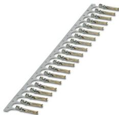
Contatto a crimpare, Femmina, in rotolo, diametro contatti: 1,6 mm, sezione di connessione: 0,34 mm<sup>2</sup> ... 1 mm<sup>2</sup>, AWG 22...17 , materiale contatti: Lega di rame
