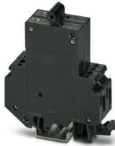
Interruttore di protezione magnetotermico, a 2 poli, rapido, con 1 contatto in chiusura e 1 contatto in apertura, con piedino universale per il montaggio su NS 32 oppure NS 35
