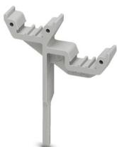
Portacartellini, inseribile nel morsetto Push-in a due piani PTTB 1,5/S, siglabile con UCT-TM 3,5, UCT-TMF 3,5, ZB 3,5 o ZBF 3,5, grigio, in bianco, tipo di montaggio: Innesto, altezza del campo di testo: 10,5 mm, larghezza del campo di testo: 3,5 mm
