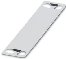
Targhetta in acciaio inox, ordinabile: a pezzi, color argento, siglatura custom, diametro cavi: 1 ... 63 mm, tipo di montaggio: Montaggio a fascette, altezza del campo di testo: 19 mm, larghezza del campo di testo: 65 mm
