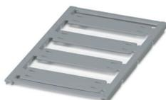
Targhetta per cavi, Scheda, argento, in bianco, siglabile con: BLUEMARK E.CARD, BLUEMARK ID COLOR, BLUEMARK ID, BLUEMARK CLED, PLOTMARK, CMS-P1-PLOTTER, tipo di montaggio: Montaggio a fascette, diametro cavo: > 7 mm, Numero dei cartellini singoli: 4, altezza del campo di testo: 15 mm, larghezza del campo di testo: 44 mm
