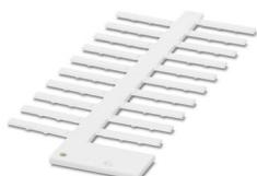
Targhetta per cavi, ordinabile: a righe, bianco, siglatura custom, diametro cavi: 1,5 ... 35 mm, tipo di montaggio: infilare, altezza del campo di testo: 4 mm, larghezza del campo di testo: 23 mm
