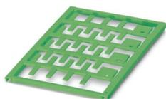
Segnaconduttori, Scheda, verde, in bianco, siglabile con: BLUEMARK ID COLOR, BLUEMARK ID, BLUEMARK CLED, PLOTMARK, CMS-P1-PLOTTER, diametro cavi: 0,6 ... 10 mm, tipo di montaggio: inserire, Numero dei cartellini singoli: 32, altezza del campo di testo: 4 mm, larghezza del campo di testo: 12 mm
